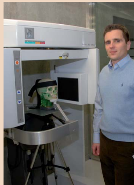
Stand im Mittelpunkt des Interesses, der KaVo 3D eXam. Aufnahmevolumen bis zu 23 x 17 cm. Die kleinere Variante mit einem Aufnahmevolumen von 14 x 8 cm: Gende CXCB-500 von KaVo.
